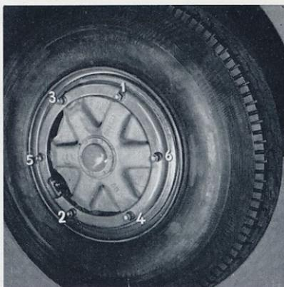
06-12 - Reihenfolge des Anzugs der Radmuttern vorn.
