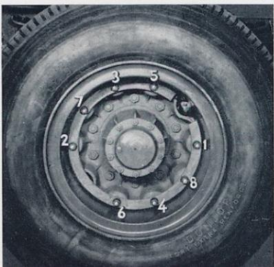
06-13 - Reihenfolge des Anzugs der Radmuttern hinten.
